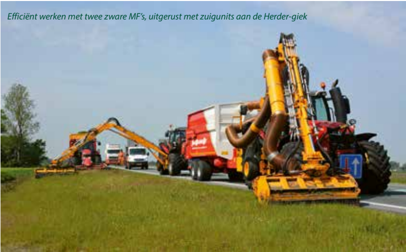
De maaibakken op de draaikop van de Grenadier kunnen in drie dimensies bewegen en 180 graden draaien.
