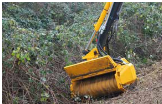
Hier mit geöffneter hydraulisch hochklappbare Vorderseite zur bessern Zufuhr von hohem Mähgut.
