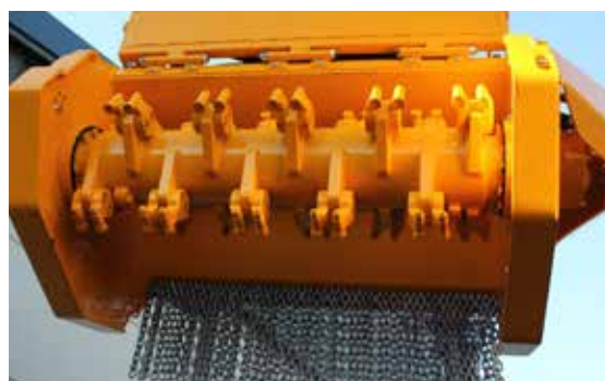
Um sicherem Arbeiten zu gewährleisten, ist der Forstmulcher an der Rückseite mit einem Kettenschutz ausgerüstet.
