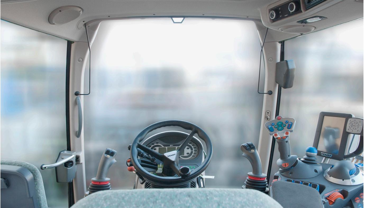
*In jedem Traktor versucht Herder stets für den Fahrer die ergonomischste Lösung zu finden. Der Joystick gewährleistet eine präzise Bedienung der Ausleger. Der Schaltschrank ist kompakt und logisch gegliedert.*
