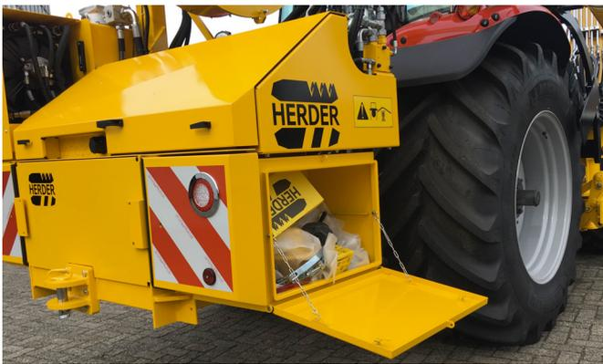
Hydraulikeinheit mit Sicherungsmarkierungen, LED Arbeitsscheinwerfer, und eine grossen Werkzeugkasten im Dreipunkt des Schleppers montiert.
