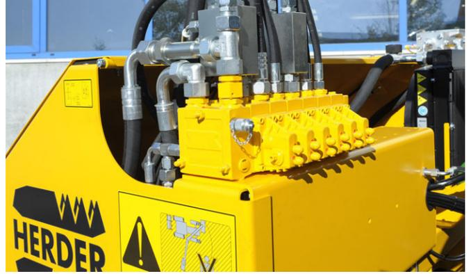
Die hydraulischen Schalt- und Bedientventile wurden sorgfältig ausgewählt und erfüllen höchste Anforderungen.
