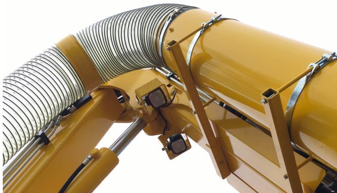
Als Option wird es möglich sein 2 LED Arbeitsscheinwerfer am zweiten Auslegerende zu montieren.
