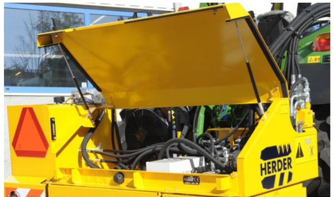
Heckklappe mit Gasfedern für gute Zugänglichkeit der hydraulischen Komponenten.
