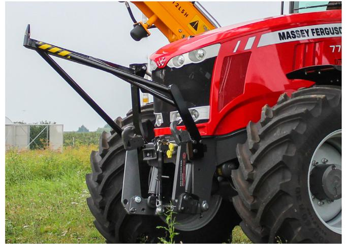
Werkzeugträger an der Vorderseite des Anbaurahmens. Hier ruht der Ausleger in Transportposition.
