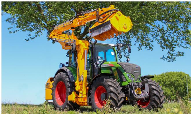
Grenadier in der 4-teiligen Pro-Ausführung. Diese Ausführung hat eine Transportposition unter der 4 Meter mit freier Sicht für den Fahrer.
