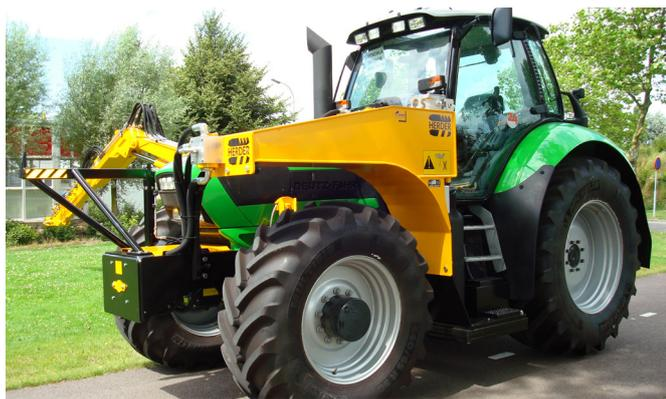
Beispiel sogenannte "Festanbau". Die Pumpen sind an die Frontzapfwelle angeschlossen und der Hydrauliktank befindet sich über dem linken Vorderrad. Bei dieser Ausführung bleiben das hintere Hubwerk und die Zapfwelle z.B. für einen Seitenschlegelmäher verfügbar.
