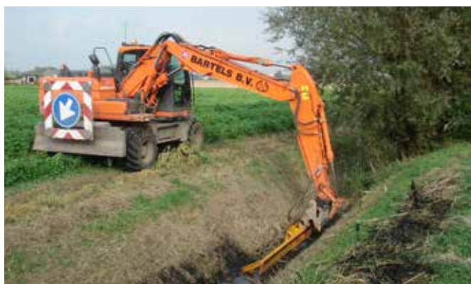
Benna falciante Herder collegata direttamente all'escavatore.
