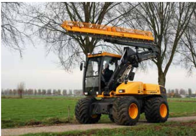
Herder può inoltre fornire bracci da sfalcio speciali per escavatori particolari quali Mecalac e macchine Gallmac. In questo caso il braccio base dell'escavatore non viene sostituito, ma la parte restante del braccio originale viene sostituita con 2 bracci speciali per l'uso in ambito falciatura. Questa soluzione consente un posizionamento particolare del braccio in fase di trasporto, garantendo la massima visibilità all'operatore nella fase di marcia su strada.
