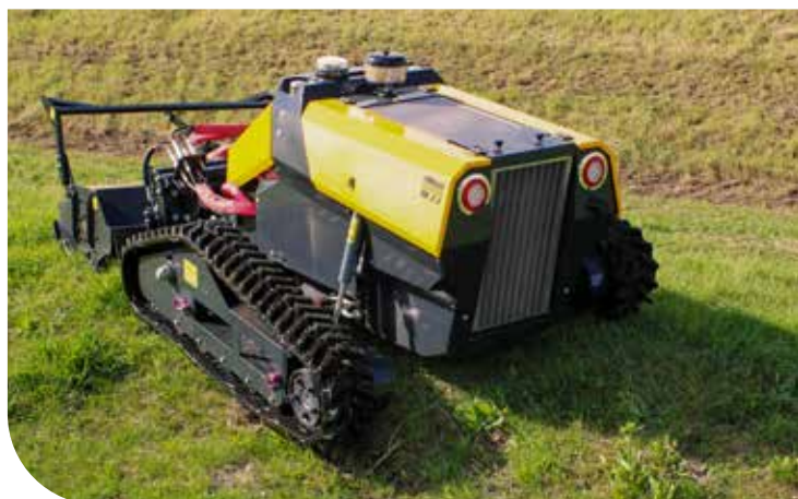
Onafhankelijk pendelende rupsen voor optimale bodemvolging en grip
