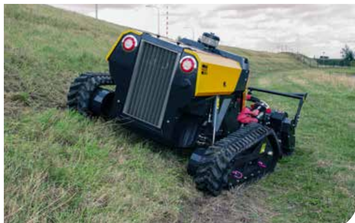
Onafhankelijk pendelende rupsen voor optimale bodemvolging en grip
