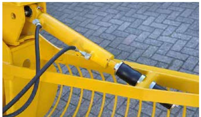
Avec un vérin de basculement, vous obtenez une position de transport à moins de 3 mètres (largeur maximale autorisée) avec les paniers faucardeurs de 4,3 et 5,5 mètres.
