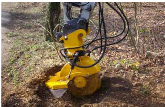
*Protezione dal lancio trucioli a regolazione idraulica per la SCE-410H (opzionale)*
