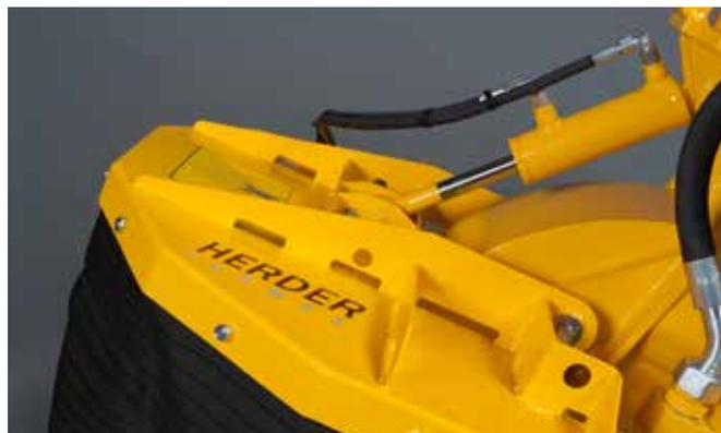
*Protezione dal lancio trucioli a regolazione idraulica per le SCE-550H, SCE-630H, e la SCE-800H (standard)*
