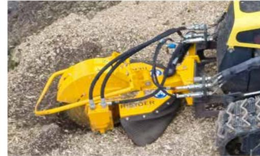
Possiamo fornire fresaceppi per ogni mezzo. I nostri fresaceppi possono essere personalizzati e realizzati in modo tale da essere adattati ad ogni mezzo dotato idraulica propria. Che si tratti di una falciatrice radiocomandata, un caricatore o altro, Herder-Fermex propone una soluzione adatta per ogni mezzo.
