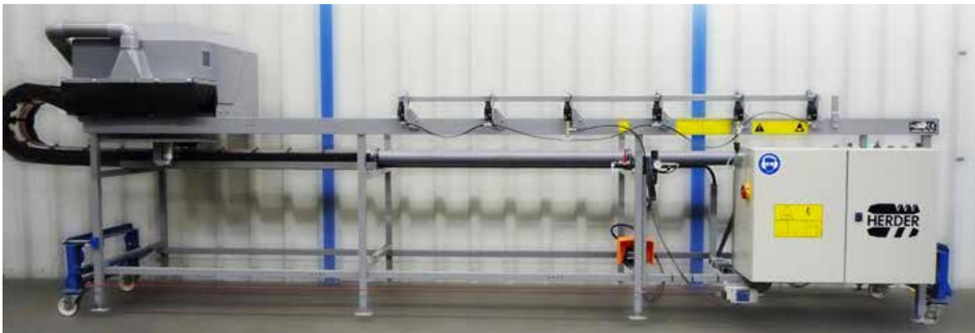
Herder hat eine automatische Schleifmaschine in 2 Arbeitsbreiten im Programm. Diese PLC-gesteuerte Maschine wurde zum Schleifen von Mähkorbmessern entwickelt. Sie haben die Wahl zwischen zwei Arbeitsbreiten von 300 oder 500 cm. Wenn eine Klemmeinrichtung montiert und andere Software installiert wird, können mit dieser Maschine auch Heckscherenmesser (Hand-Held-Version) geschliffen
